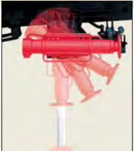
6段ブーム機は、回転格納式リヤアウトリガを標準装備。(最大張出し幅:2,890mm)
