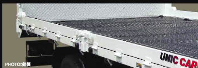
鉄製/アルミ製2分割横アオリ [H100mm×幅50mm]
