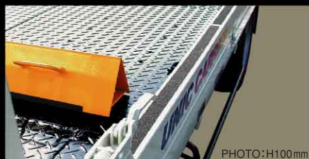
鉄製・角パイプ [H100、150mm×幅50mm]
