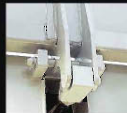
油圧開閉式リヤゲート リヤゲートの開閉が操作レバー1本でラクラク行えます。また、操作レバーは荷台後部両側に装備されています。
