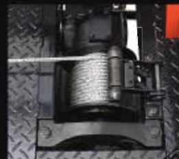
2.5t引きウインチ 3ナンバー高級車等の牽引作業に威力を発揮するクラス最高巻上能力2.5t(単索)ウインチです。
